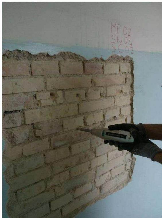
**Foto 14: Prova sclerometria su malta su muratura di mattoni**
