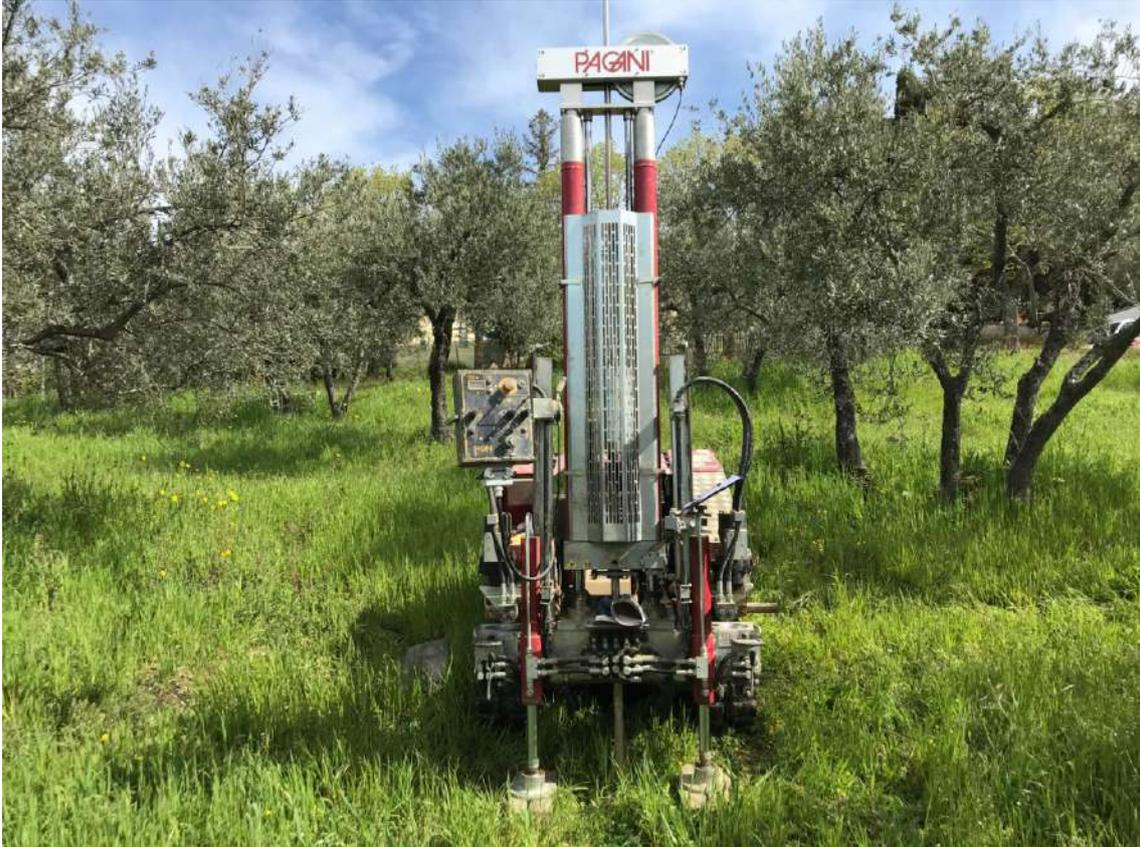
FOTO 1: Strumentazione utilizzata per l'esecuzione della prova DPSH 3.
